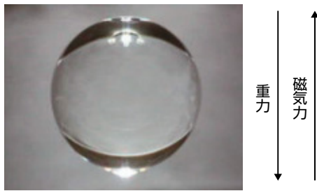
強磁場によって浮上した水の球 (直径7mm) 強力な超伝導磁石内で側面から撮影
