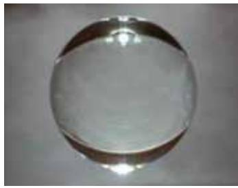
強磁場によって浮上した水の球（直径7mm）
