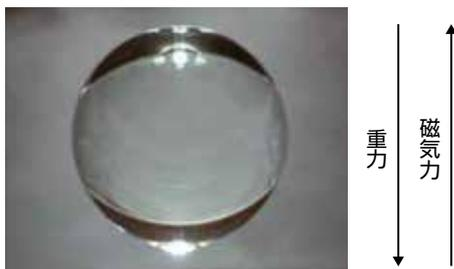
強磁場によって浮上した水の球 (直径7mm)
